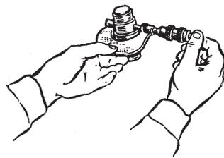
**Предельным размером ( $D_{max}$ ,  $D_{min}$ ,  $d_{max}$ ,  $d_{min}$ )** называется размер, ограничивающий интервал значений, между которыми должен находиться действительный размер годной детали.
