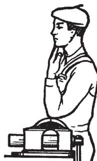
— при обработке детали, установленной в тисках, следует проверить угол между предплечьем и плечом. Угол между предплечьем и плечом должен составлять 90°;
