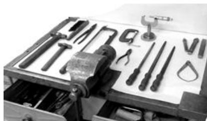
— следить за состоянием слесарных тисков и не затягивать чрезмерно винт тисков.
