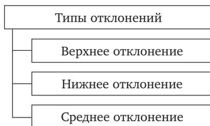
**Верхнее отклонение ( $ES$ ,  $es$ )** равно алгебраической разности между наибольшим предельным и номинальным размерами.
